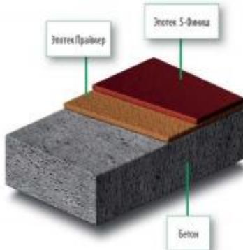
**ЭПОТЕК S-Финиш – двухкомпонентное эпоксидное покрытие полов без растворителя, предназначенное для создания механически и химически стойкой и легко очищаемой поверхности. Стойкое к маслам, нефтепродуктам, слабым кислотам и щелочам.**
